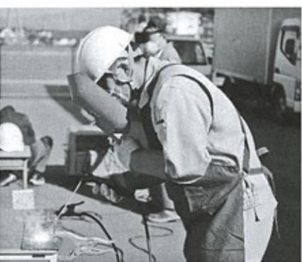
一定の幅で真っ直ぐに引く練習を行います。最初はスパークさせるだけでも難しいのでひたすら練習！
