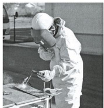
一定の幅で真っ直ぐに引く練習を行います。最初はスパークさせるだけでも難しいのでひたすら練習！
